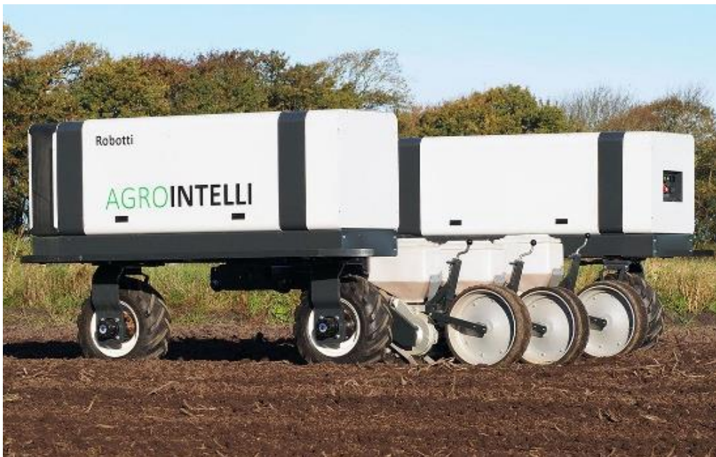
Billede 5: Robotti er en autonom redskabs-bærer med en arbejdsbredde på 1,8-3 m. En operatør kan kontrollere og overvåge op til 5 Robotti via en tablet (kilde: www.agrointelli.com )
