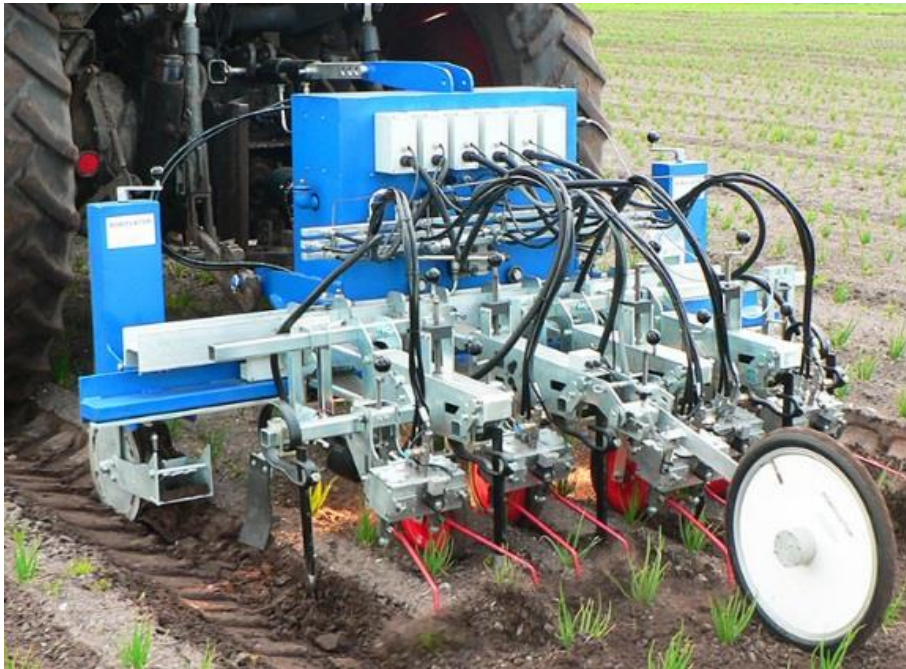
Billede 1: Robovator fra Frank Poulsen Engineering kan rense ukrudt i rækken i plante afgrøder med en hastighed på 1–4 km pr. time (kilde: www.visionweeding.com )
