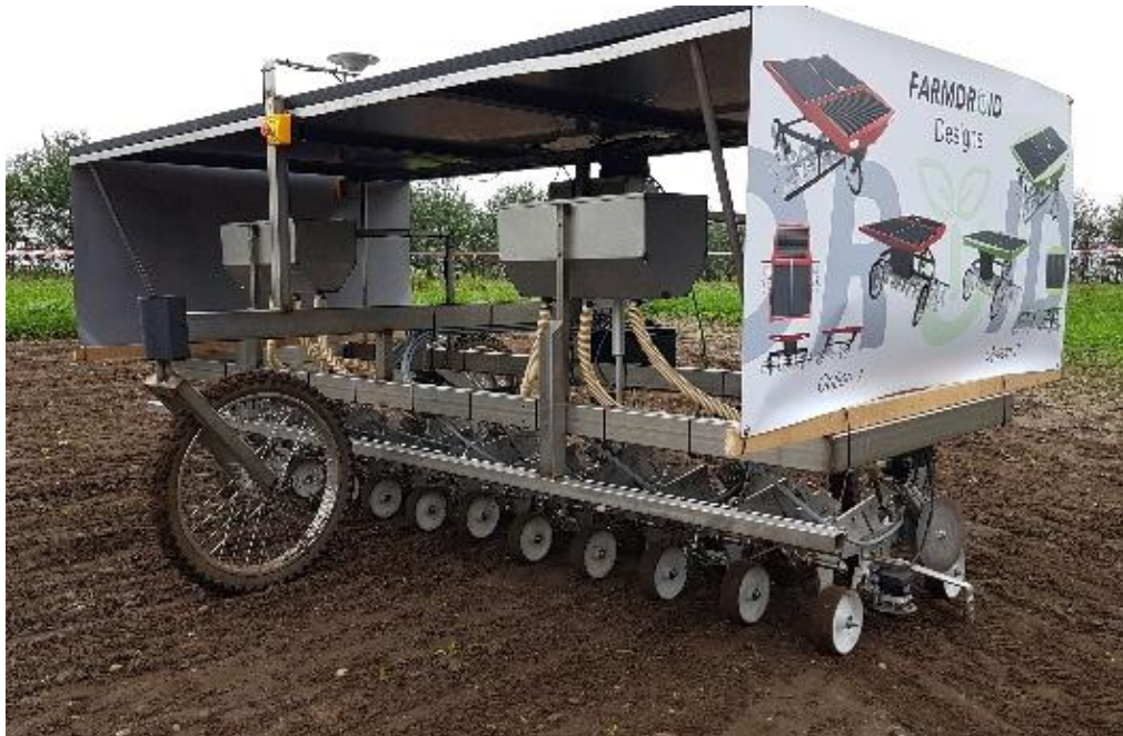
Billede 6: FarmDroid-robotten sår og renser roer. Frøene placeres med GPS i rækker og/eller koordinatsystem. Lugning og radrensning guides via GPS uden kamera ( www.maskinbladet.dk , foto: Sven Hermansen, SEGES).
